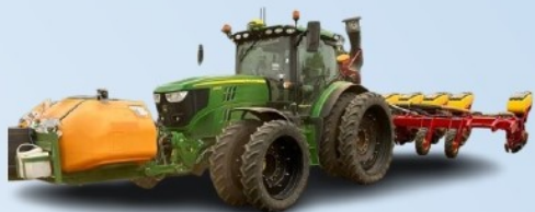
Kit application localisée engrais starter liquide
