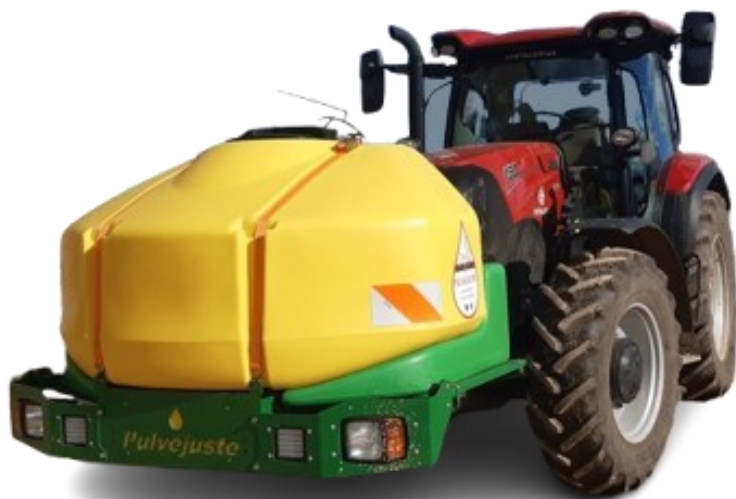
Cuve Fibra 1500 litres avec cuve rinçage.
