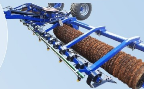
Rampe de pulvérisation adapté aux outils
