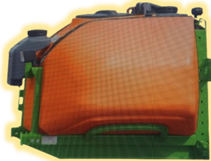
Cuve Physeter 1200 litres H 1100 x largeur 1850 x prof 1400 mm
